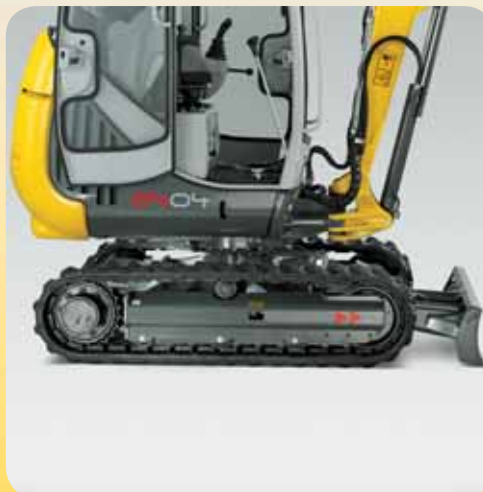
Les bâtis de chenilles particulièrement longs et larges garantissent une stabilité sans faille, y compris sur les terrains les plus accidentés. La maniabilité et la puissance de la pelle peuvent toujours être pleinement exploitées.
